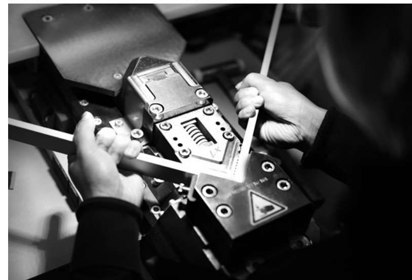
Mithilfe einer von HALBE entwickelten Spezialmaschine werden die Aluminiumprofile gestaucht, verprägt und verbunden. Moderne Technik und Fingerspitzengefühl schaffen so die perfekte Gehrung.
