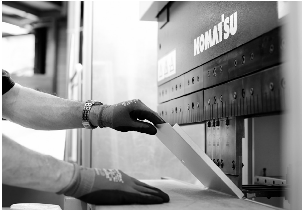
CNC-gesteuerte Abkantpresse zum maßgenauen Fertigen von Blechwindeln oder ganzen Grundelementen. Mit ihr lassen sich auch Mehrfachkantungen verwirklichen.
