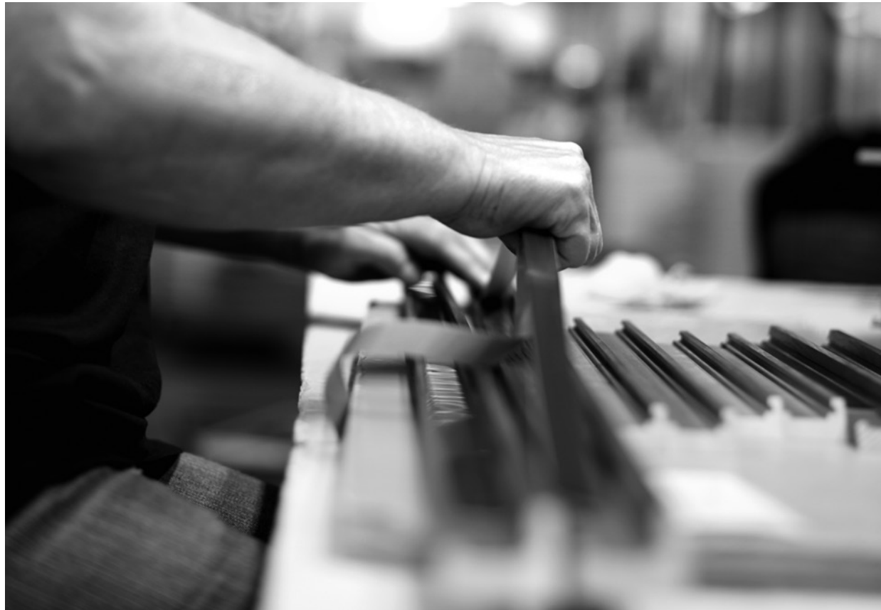
Einsetzen der Magnetbänder. Sie sind der Kern aller HALBE Rahmen – ob aus Holz oder Aluminium. Die Metallpartikel sind in Kunststoff eingegossen. So halten sie ihre Magnetkraft dauerhaft.
