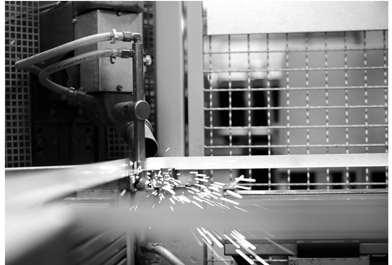
Verschweißen des Blechwinkelverbundes. Dieser wird mit minimalen Toleranzen auf Maß gebracht und dauerhaft verbunden – das gewährleistet Langlebigkeit auch bei häufigem Bildwechsel.
